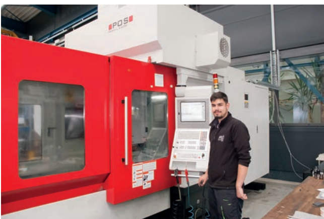
Bild 9: Mit den beiden neu angeschafften 3-achsigen Bearbei- tungszentren POSmill E2050 werden zurzeit hauptsächlich die formgebenden Bereiche von Werk- zeugen für nach- gelagerte Prozesse zur weiteren Ober- flächenveredelung gefräst, was auch die Hartbearbeitung mit einschließt
