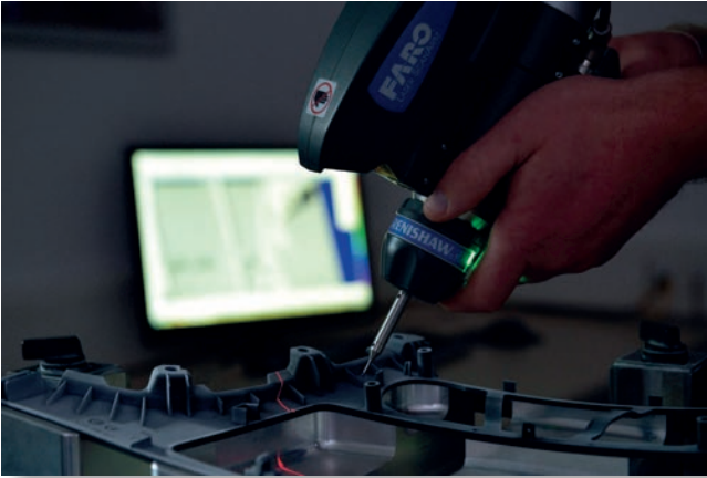
Bild 10: Qualität wird bei ERBIWA großgeschrieben: Handgeführtes Koordinatenmessgerät beim Messen der Geometrien eines gespritzten Teils
