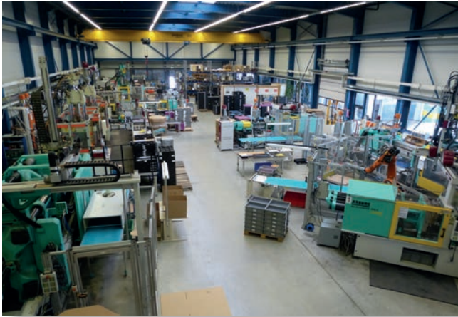
Bild 8: Ein zweites Stand- bein bildet die Serienproduktion von Kunststoffteilen, vorwiegend Sicht- und Dekorteile für PKW, wofür die ERBIWA tech GmbH zuständig ist. Die Spritzgussmaschi- nen dienen zudem als Technikum zur Musterung von Werkzeugen und zum Test von Hand- lingsystemen
