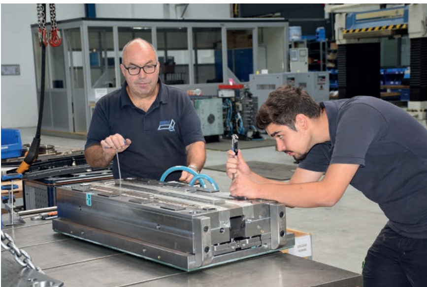
Bild 7: Bei ERBIWA entstehen Spritzgießwerkzeuge und ganze Werkzeugfamilien in unterschiedlicher Bauart mit bis zu zehn Tonnen Gewicht. Mechanisch gefertigt werden fast alle Teile bei Partnerunternehmen – und bei ERBIWA Mould Industrial in China
