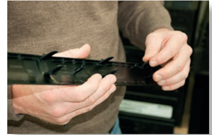
Bild 6: Matthias Wagner und ein hinter-spritztes Aluminiumteil, das als Einstiegs-leiste für die BMW 7er-Reihe direkt ans Band geliefert wird
